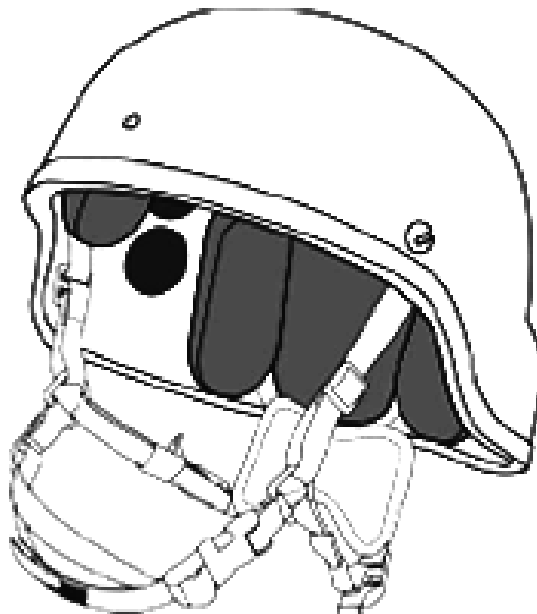
Σχήμα 2: Κέλυφος Κράνους με το σύστημα ανάρτησης και το σύστημα απορρόφησης κραδασμών
