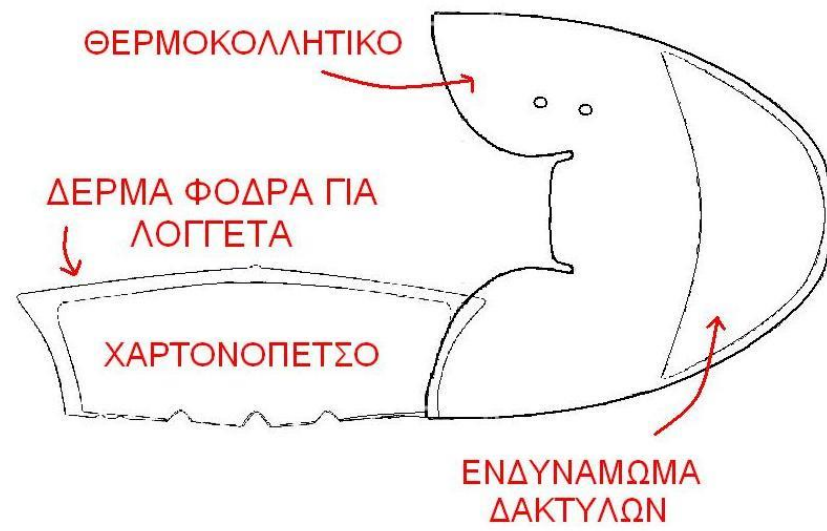
Σχ. 8 Μοντάρισμα εσωτερικά
