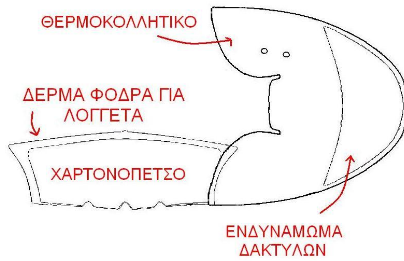
Σχ. 7 Μοντάρισμα εσωτερικά
